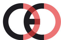
Falsk CE-mærke (for tæt på hinanden)
